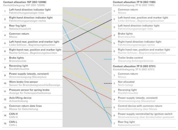
Connection wires for pole 10 to 12 are ready for use in 15P housing Anschlüsse für Pol 10 bis 12 liegen im 15P Gehäuse bereit
